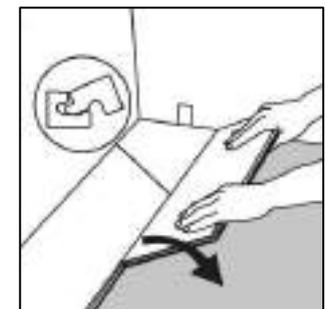
Drücken Sie die erste Diele der ersten Reihe in einem Winkel gegen die zuvor verlegte Reihe. Drücken Sie diese nach vorne und gleichzeitig vorsichtig nach unten.
