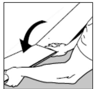
Markieren Sie, wo die Diele abzuschneiden ist und platzieren Sie diese auf die Arbeitsoberfläche, um sie mit einer Säge auf die richtige Größe zu zuschneiden.
